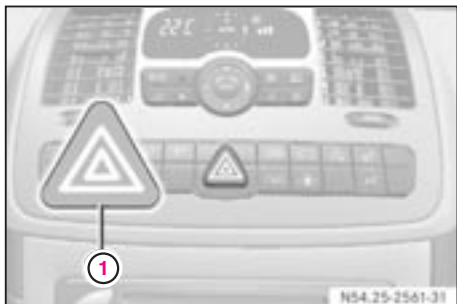
① 非常点滅灯スイッチ
