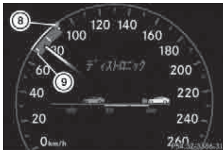
⑧ ディストロニックインジケーター ⑨ 先行車の走行速度
