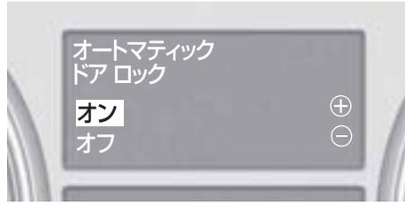
走行速度が約 15km/h 以上になったときに、ドアとテールゲートを自動的に施錠する機能の設定ができます。
