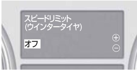
最高速度の制限のない国などで、ウィンタータイヤ装着時にタイヤの許容最高速度に応じた最高速度を設定するための機能です。
