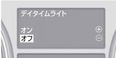
ヘッドランプの点灯モードの設定ができます。
