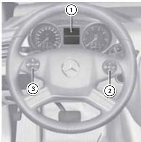
マルチファンクションディスプレイの操作は、ステアリングのスイッチで行ないます。
