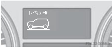
オフロードレベルになると、マルチファンクションディスプレイに "レベル Hi" と表示され、スイッチの表示灯②が点灯します。
