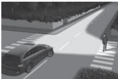
以下のときに、方向指示灯の点滅、またはステアリング操作に連動して、フロントフォグランプが点灯します。
