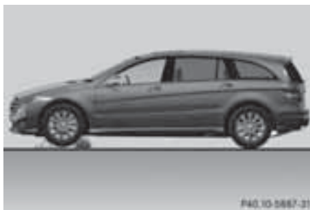
水平な地面での輪止めの使用方法
