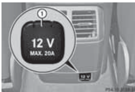
センターコンソール後方の電源ソケット
