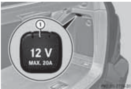
ラゲッジルームの電源ソケット
