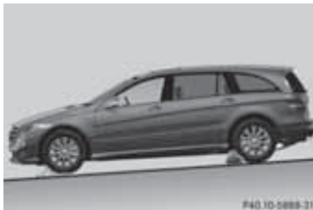
傾斜した地面での輪止めの使用方法
