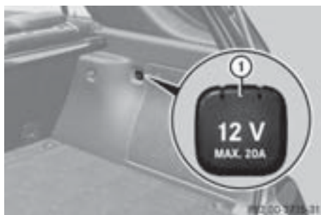
ラゲッジルームの電源ソケット
