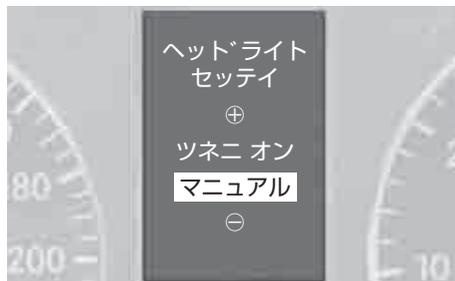
ヘッドランプの点灯モードの設定ができます。
