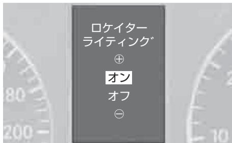
周囲が暗いときにリモコン操作で解錠すると車外ランプが点灯する機能の設定ができます。
