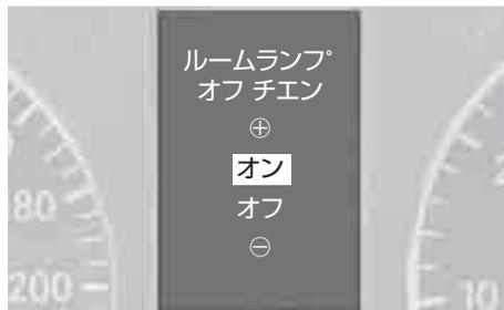
ルームランプが自動点灯モードで周囲が暗いときにエンジンスイッチからキーを抜くと、ルームランプが点灯する機能の設定ができます。
