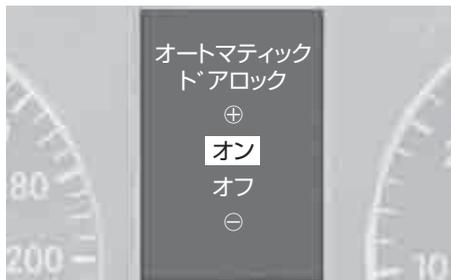
走行速度が約 15km/h 以上になったときに、ドアとテールゲートを自動的に施錠する機能の設定ができます。
