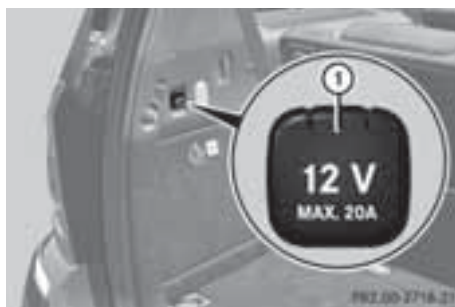
ラゲッジルームの電源ソケット
