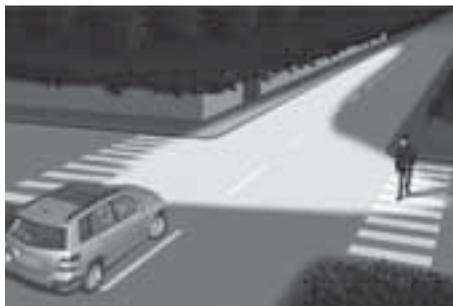
エンジンがかかっていてヘッドライトを点灯しているときに、方向指示灯の点滅、またはステアリング操作に連動して、コーナリングライトが点灯します。
