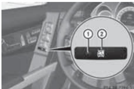
リアドアのスイッチによるリアドアウインドウの操作ができなくなります。
