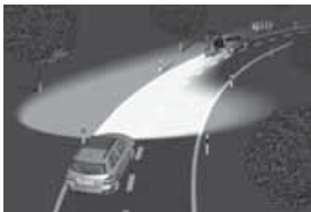
ヘッドライトが下向きで点灯しているとき、走行中にステアリングを操作すると、操作した方向にヘッドライトの向きが変わります。
