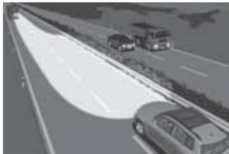
ヘッドライトの照度や照射範囲を自動的に調整します。
