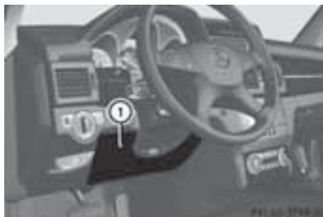
運転席ニーバッグ①は、運転席エアバッグに連動してステアリングの下方で作動し、乗員の膝から下への衝撃を分散・軽減します。
