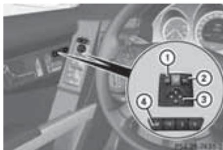
セレクターレバーを **R** に入れたときに、助手席側ドアミラーの角度があらかじめ記憶させていた角度になり、車両後方の視界を確保して、後退を容易にします。
