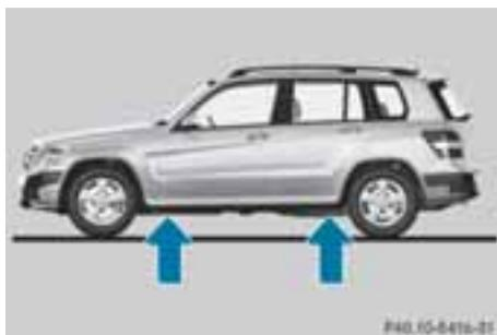
ジャッキサポートは前輪の後方、後輪の前方のボディ下部4カ所（矢印の位置）に設けられています。
