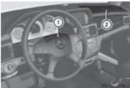
運転席エアバッグ①はステアリング前部で、助手席エアバッグ②はグローブボックス前部および上部で作動し
