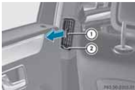
① リアサイド送风口 (左側) ② リアサイド送风口開閉ダイヤル
