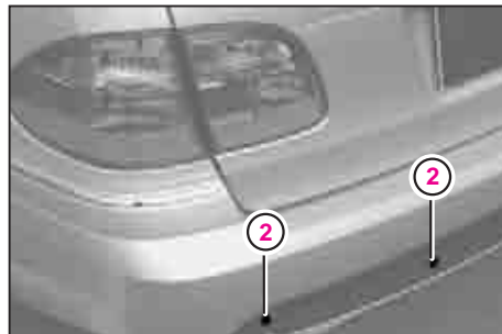
リア (ステーションワゴン) ② センサー
