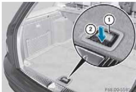
ラゲッジフロアボード下の収納スペースには、ラゲッジバスケットと停止表示板ケース、車載工具が収納されています。
