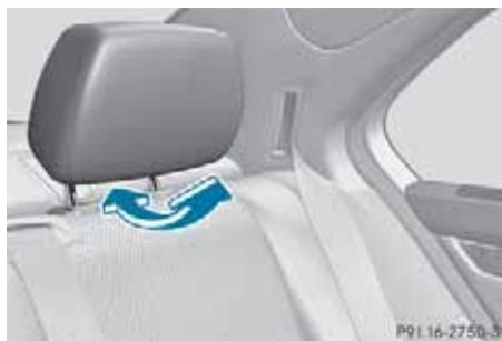
▶ ヘッドレストを動かして角度を調整します。
