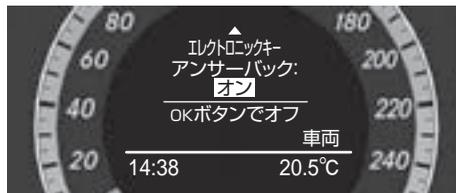
リモコン操作またはキーレスゴー操作 \* で車両を解錠 / 施錠したときの確認音が設定できます。
