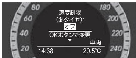
最高速度の制限のない国などで、ウィンタータイヤ装着時にタイヤの許容最高速度に応じた最高速度を設定するための機能です。
