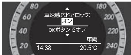
走行速度が約 15km/h 以上になったときにドアとトランクまたはテールゲートを自動的に施錠する機能の設定ができます。
