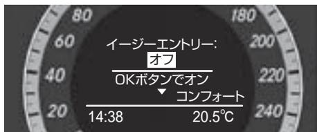
以下のときにステアリングが上方に移動する、イージーエントリーの設定ができます。
