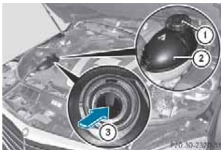
▶ リザーブタンク②のキャップ①を反時計回りにゆっくり約1回転までまわして、圧力を抜きます。
