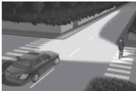
以下のときに、方向指示灯の点滅、またはステアリング操作に連動して、コーナリングランプが点灯します。
