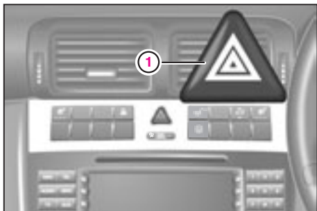
① 非常点滅灯スイッチ
