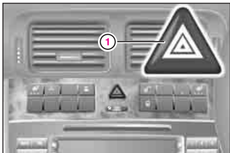
① 非常点滅灯スイッチ
