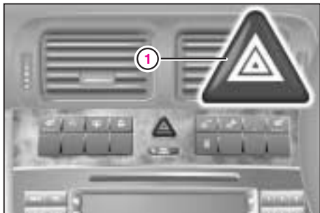
① 非常点滅灯スイッチ
