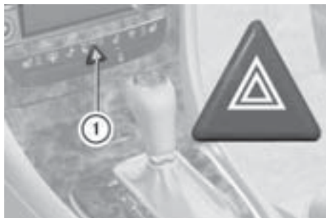
① 非常点滅灯スイッチ
