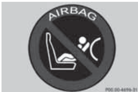
チャイルドセーフティシートを後ろ向きに装着することを禁止する警告ステッカー
