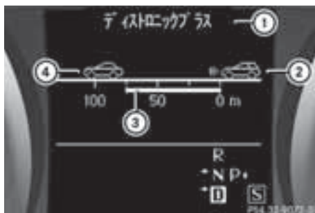
ディストロニック・プラス作動中のマルチファンクションディスプレイの車間ディスプレイ
