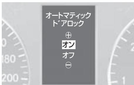
走行速度が約 15km/h 以上になったときに、ドアとテールゲートを自動的に施錠する機能の設定ができます。
