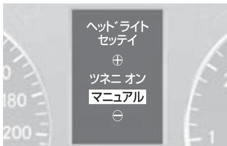
ヘッドランプの点灯モードの設定ができます。
