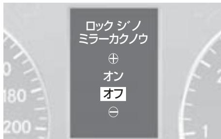
リモコン操作での施錠時にドアミラーを格納する機能の設定ができます。
