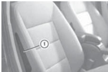
横方向からの強い衝撃を受けると、衝撃を受けた側のサイドバッグ①が作動し、乗員の胸部への衝撃を分散・軽減します。
