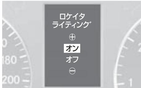
周囲が暗いときにリモコン操作で解錠すると車外ランプが点灯する機能の設定ができます。
