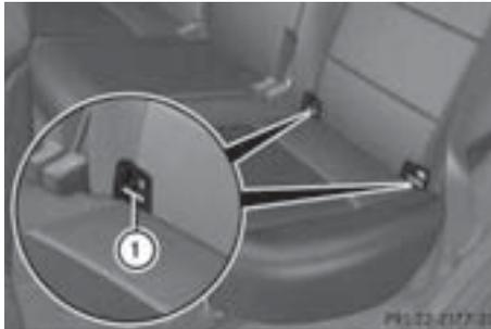
左右の後席に、ISO-FIX 対応チャイルドセーフティシート用の固定装置①を装備しています。
