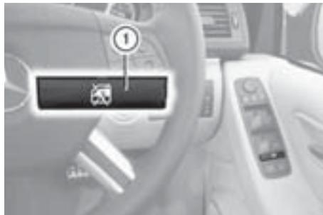
リアドアのスイッチによるリアドアウインドウの開閉ができなくなります。
