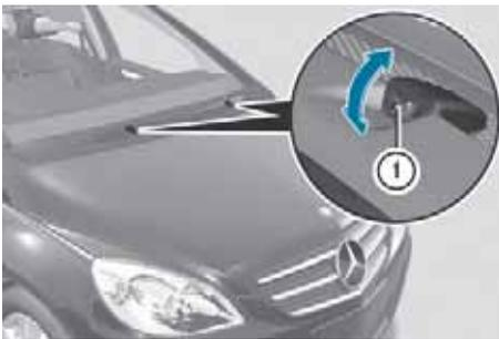
ウォッシャー液の上下の噴射方向を正しく調整してください。
