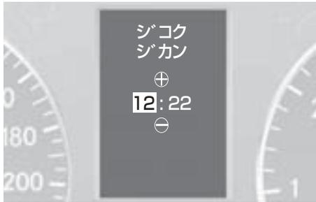
車両情報サブ画面の時刻表示の「時」を設定します。
