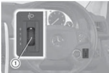
乗員数が増えたり荷物を積載してヘッドランプの照射角度が変わったときに調整します。
