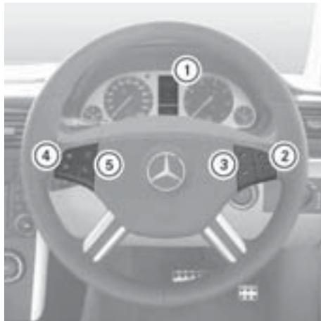
マルチファンクションディスプレイは、故障 / 警告メッセージや各種情報などを表示・設定するシステムです。マルチファンクションディスプレイの操作は、ステアリングのスイッチで行ないます。
