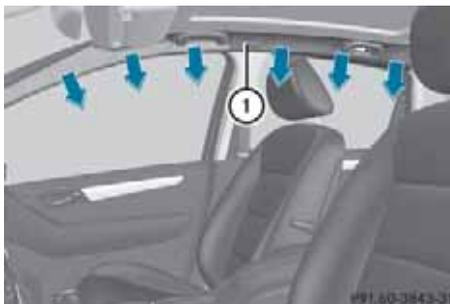
横方向からの強い衝撃を受けると、衝撃を受けた側のウインドウバッグ①が作動し、頭部への衝撃を分散・軽減します。
