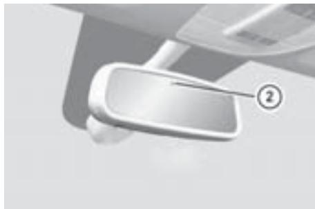
周囲が暗くエンジンスイッチが1か2の位置のとき、ルームミラーのセンサー②が後続車のライトを感知すると、自動的にルームミラーの色の濃度が変わり眩しさを防止します。
