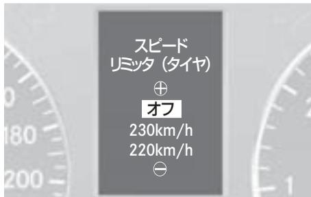
最高速度の制限のない国などで、ウィンタータイヤ装着時にタイヤの許容最高速度に応じた最高速度を設定するための機能です。
